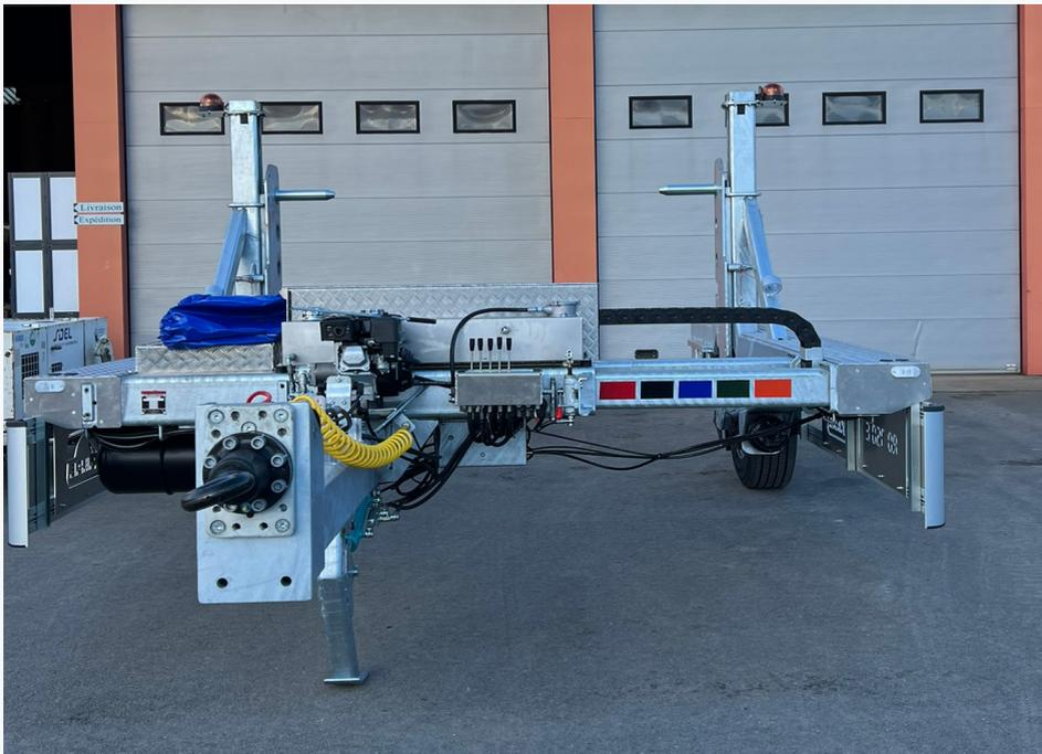
L'élargissement est réalisé par deux vérins hydrauliques situés dans la traverse avant du châssis et dans la barre anti-encastrement.
