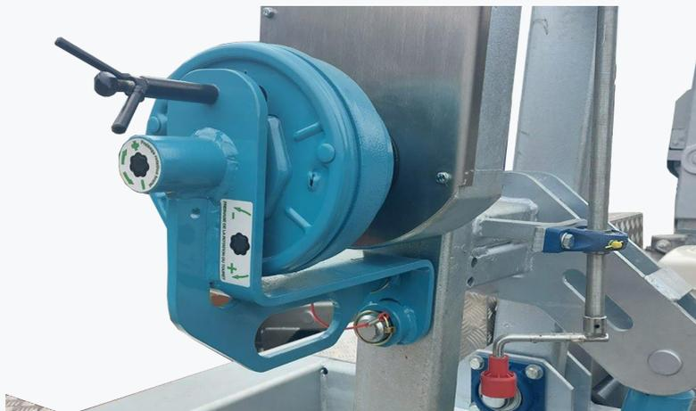
Les 2 freins de bobine doivent être insérés dans le bras de la motorisation de chaque côté afin de permettre l'activation du freinage.
