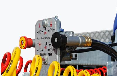
**Les 3 systèmes sont à mettre en place avant tout départ sur le camion** (3 systèmes comportant 4 branchements). **Une fois la remorque attachée**, enfoncez le bouton rouge. **Vérifiez** que les feux et les freins fonctionnent correctement.
