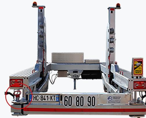
**Enlevez** l'axe de verrouillage. Pivotez la barre anti-encastrement jusqu'au côté opposé. **Verrouillez** la barre en position ouverte à l'aide de l'axe. Cela permet un accès total à la remorque.
